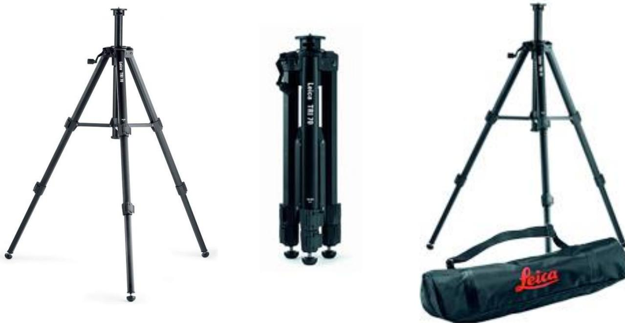
Gracias a su tamaño pequeño de 45 cm de longitud y peso de 1,4 kg, el trípode leica TRI 70 es muy cómodo para llevar en las obras. El trípode tiene una rosca 1/4" y cabezal giratorio. Puede realizar trabajos de altura de 40 hasta 115 cm, apretadores excéntricos en cada una de las patas que facilitan la colocación en altura deseada. Nivel de burbuja que facilita la nivelación.
