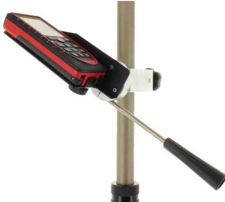
El Soporte Leica Disto LSA360-S permite montar los Distos Leica S910, D810, E7500i, D510, E7500 y D410 en un bastón de diámetro entre 11mm y 35mm (0.45" -1.35").
