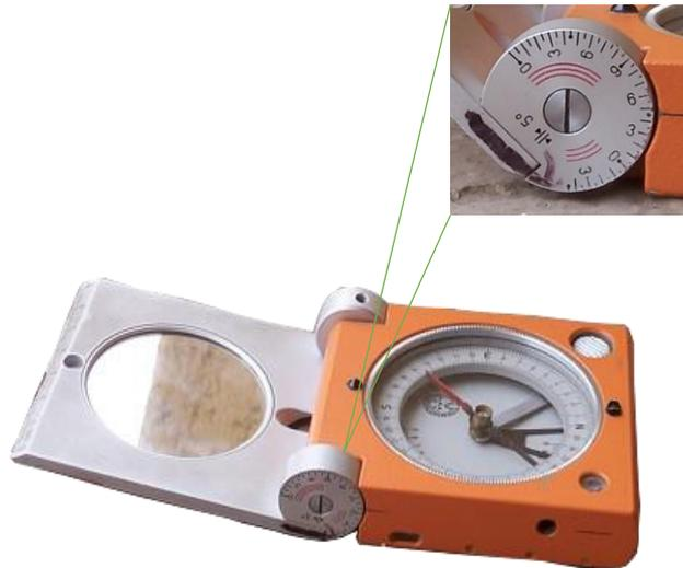
La Brújula Freiburger nos permite tomar los datos en una forma rápida y segura, principalmente se toman datos del tipo círculo completo, mediciones de círculo completo (dirección de inclinación/ manteo), también se puede tomar excepcionalmente datos del tipo americano (Rumbo, manteo, dirección, etc...).
