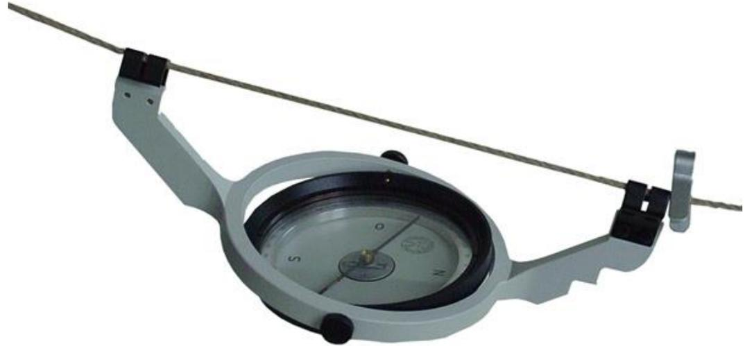
La brújula de prospección minera es un instrumento simple y efectivo para topografía minera, para medir posiciones y alturas en todas las situaciones, para la exploración de cuevas, para la planificación topográfica y la estratificación de rocas por encima y debajo del suelo y para replantear reclamaciones y sitios.
